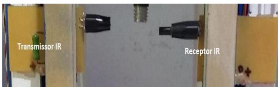
FIGURA 2 - Sensores de posição do LV.
